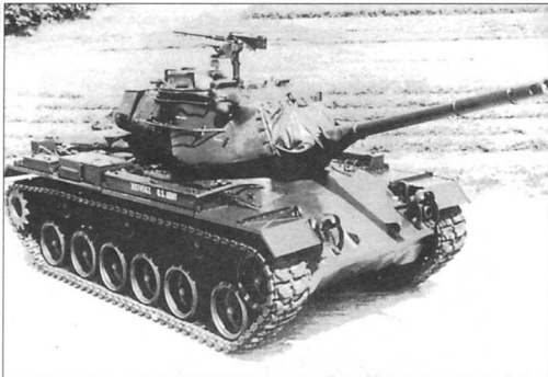
Модернизированный танк М47М с 750-сильным дизелем AVDS-1790-2А и МТО, заимствованным у танка М60
