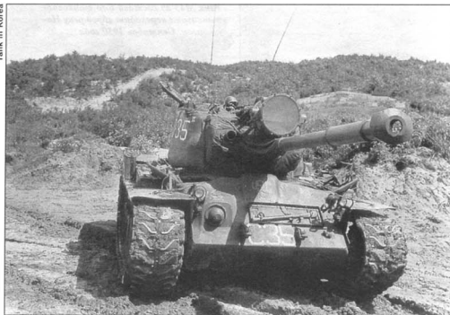
Танк M46 1-го танкового батальона морской пехоты, оснащенный «пржектором боевого света» фирмы General Electric. Эти прожекторы оказались весьма эффективны при отражении ночных атак китайской пехоты. Корея, лето 1953 года
